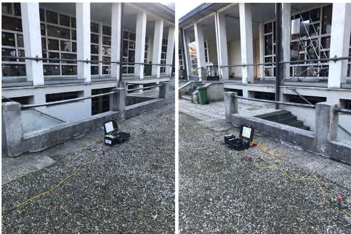
Esecuzione della prova sismica MASW.
